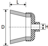
Für schwere Bürstarbeiten auf großen Flächen einsetzbar, wie Reinigen, Entrosten, Entzundern, und Entgraten.
