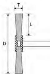
Universell einsetzbar zum Reinigen, Entrosten, Glätten, Entzundern, Putzen von Gussnähten, leichten Entgraten und Entfernen von Korrosion und Lackschichten.
