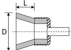
Für leichte Bürstarbeiten wie Reinigen, Entrosten und Entgraten. Besonders geeignet zum Arbeiten an unzugänglichen Stellen in Bohrungen und Hohlräumen, da sich der Besatz durch die Rotation aufspreizt.
