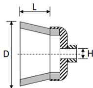
Für mittelschwere Bürstarbeiten auf großen Flächen einsetzbar, wie Reinigen, Entrostern, Entzundern, und Entgraten.
