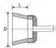
Universell einsetzbar zum Reinigen, Entrosten, Glätten, Entzundern, Putzen von Gussnähten, leichten Entgraten und Entfernen von Korrosion und Lackschichten auf großen, ebenen Flächen.
