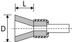
Für mittlere Bürstarbeiten wie Reinigen, Entrosten und Entgraten. Besonders geeignet zum Arbeiten an unzugänglichen Stellen in Bohrungen und Hohlräumen, da sich der Besatz durch die Rotation aufspreizt.
