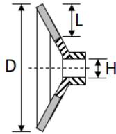
Für schwere Bürstarbeiten an schwer zugänglichen Stellen einsetzbar, wie Reinigen, Entrosten, Entzundern, und Entgraten.
