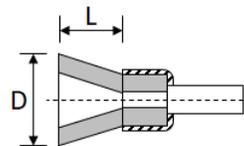
Für leichte Bürstarbeiten wie Reinigen, Entrostern und Entgraten. Besonders geeignet zum Arbeiten an unzugänglichen Stellen in Bohrungen und Hohlräumen, da sich der Besatz durch die Rotation aufspreizt.
