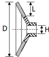
Für mittelschwere Bürstarbeiten an schwer zugänglichen Stellen einsetzbar, wie Reinigen, Entrosten, Entzundern, und Entgraten.
